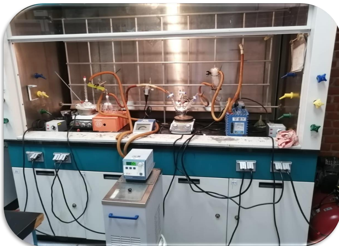
Figura 20. Sistema para la purificación del monómero 3HT.
