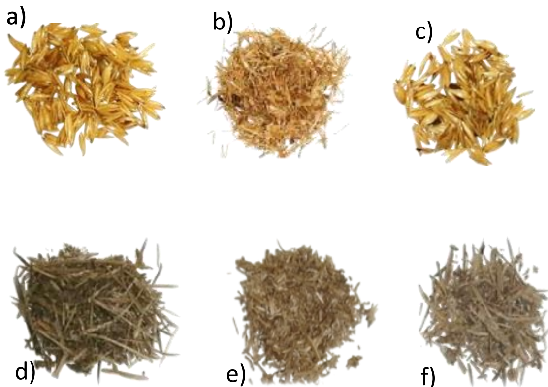
Figura 17. Aspecto del material: CA a) sin tratamiento, b) con tratamiento de HCl 1.0 M, c) con tratamiento de \text{CH}_3\text{COOH} 1.0 M; BC d) sin tratamiento, e) con tratamiento de HCl 1.0 M, f) con tratamiento de \text{CH}_3\text{COOH} 1.0 M
