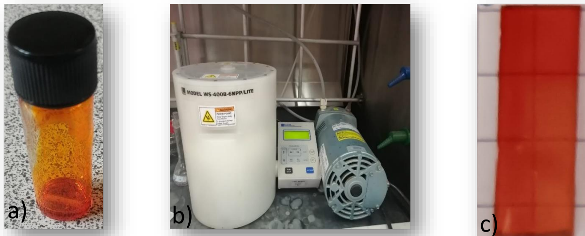
Figura 26. Fabricación de películas: a) solución polimérica, b) equipo Spin-Coating y c) película depositada por Spin-Coating
