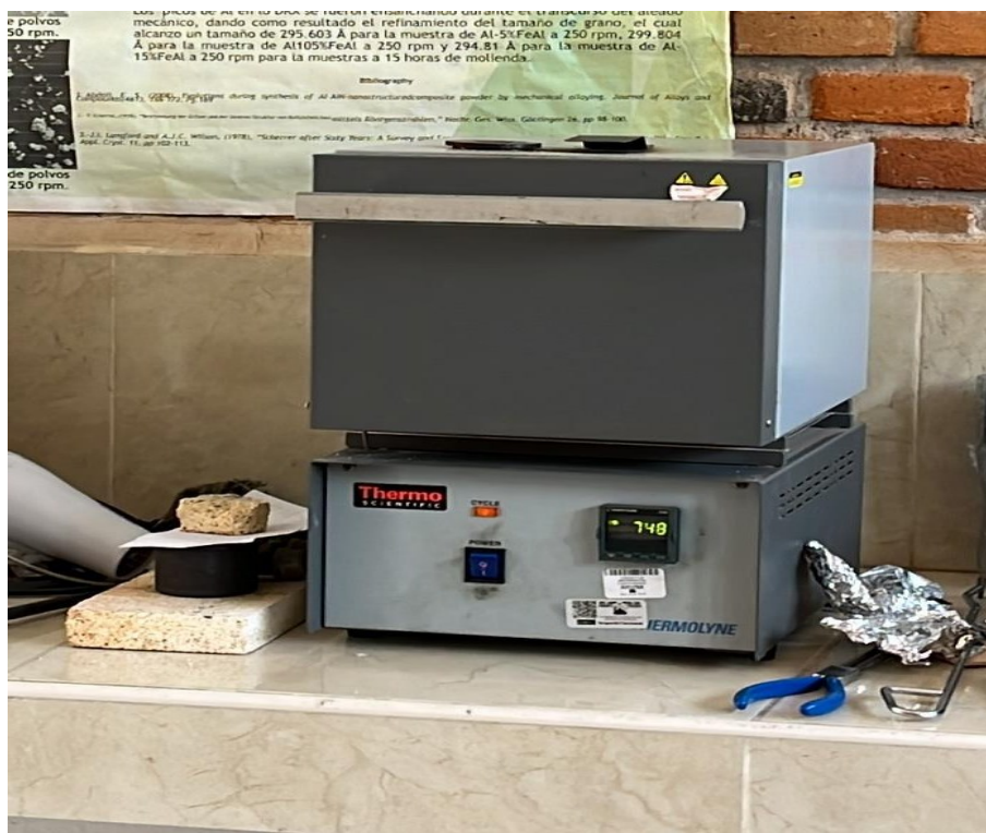
Preparacion de la mufla electrica
