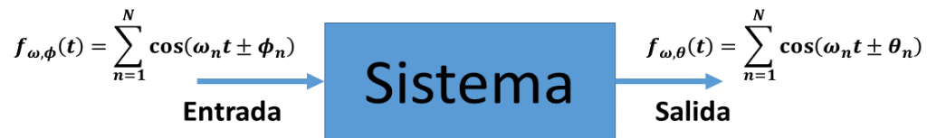
Figura 4. 45: Diagrama del sistemas para emplear el fasor de \mathcal{T}_e .
