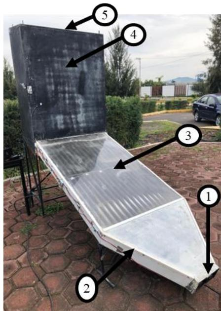
**Figura 1.2 Partes del secador solar, donde: (1) entrada del secador, (2) carcasa de acero inoxidable, (3) colector solar, (4) cámara de secado, (5) salida del secador**
