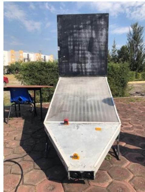
**Figura 3.2** Ubicación de anemómetros entrada del colector solar
