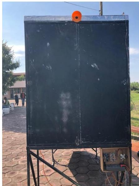
**Figura 3.3** Ubicación del anemómetro a la salida del secador
