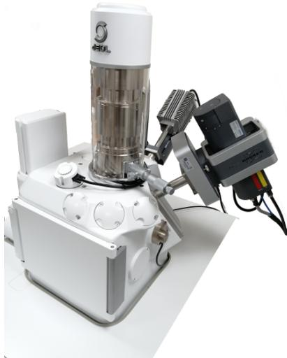
Figura 29: Equipo utilizado. Microscopio electrónico JEOL© JSM-IT500, tiene acoplado un detector Bruker© XFlash 6/30 y una fuente de rayos XBruker© Xtrace.
