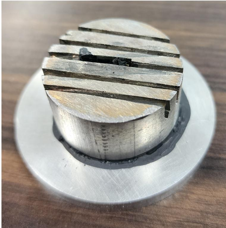
Figura 30: Montaje listo para ser observado en el microscopio electrónico. En el porta muestras de sección transversal se colocó un corte del abdomen de la mosca sobre la superficie de la cinta de carbono.
