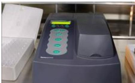
Figura 32. Espectrofotómetro de luz visible/UV marca Genesys 20 (Colección propia).
