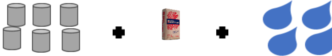
Figura. 4: La mezcla tiene una consistencia chiclosa cuando está preparada. No debe estar arenosa y contaminada con piedras, tierra o con papel del bulto de cemento. Xochitepec, Mor., Cristian Salas Juárez, 2022.
