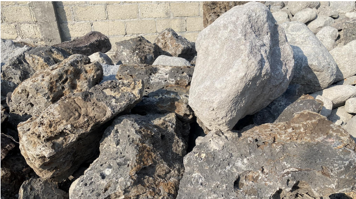
Foto 43: Piedra de tezontle o volcánica y piedra de mina o bole. Xochitepec. Mor., Cristian Salas Juárez, 2023.
