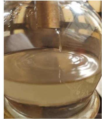
Ilustración 6 Extracción por arrastre de vapor de Aceite esencial de salvia ( Salvia officinalis )
