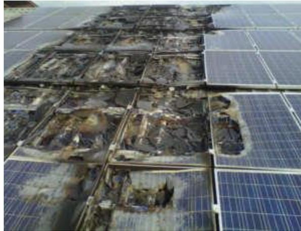
Figura. 8 Efecto Hostpot en panel solares.
