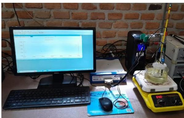
Figura 5.2. Arreglo instrumental estudio de corrosión.
