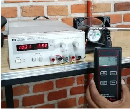
Figura 4.9 Medida del aire un solo ventilador.
