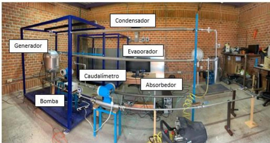
Figura 6.9 Ensamble final del sistema de enfriamiento
