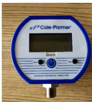
Figura 6.4. Manómetro digital.
