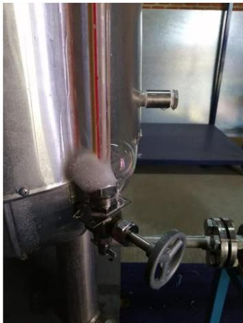
Figura 6.12 Fuga en el sistema.
