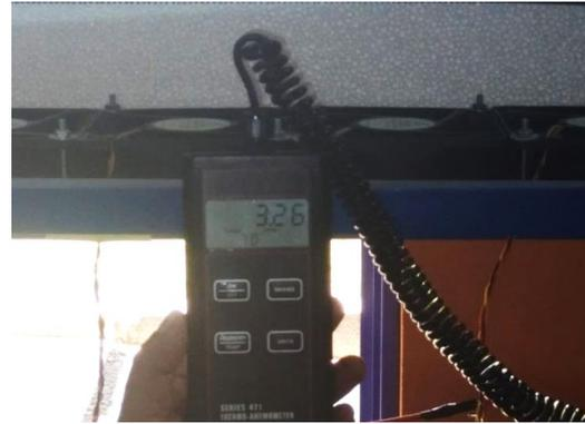
Figura 4.10 Medida del aire en banco de ventiladores.
