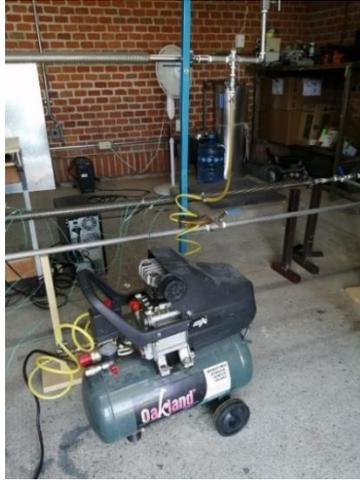
Figura 6.11 Presurización del sistema de absorción.
