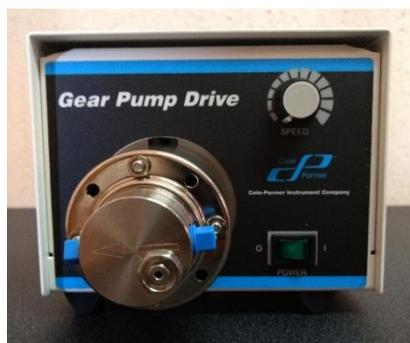
Figura 6.3. Bomba de velocidad variable.
