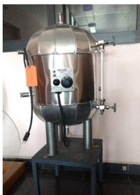
Figura 6.2. Generador con mirilla y resistencia eléctrica acoplada.
