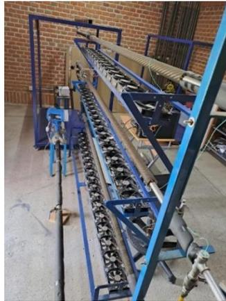
Fig. 6.14 Banco de ventiladores de los intercambiadores de calor.
