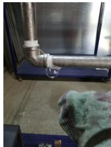
Figura 6.13 Fuga en el sistema.
