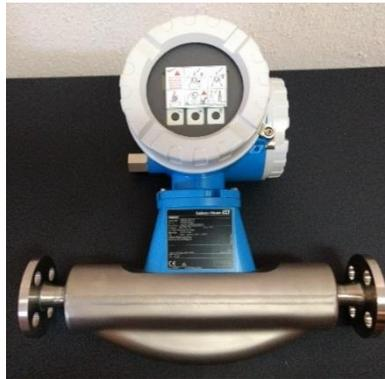
Figura 6.5. Medidor de flujo Coriolis.
