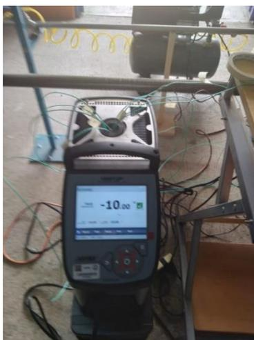
Figura 6.16 Calibración de termopares mediante calibrador JOFRA.
