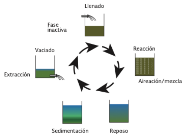
Figura 3. Esquema general para el tratamiento secundario de aguas residuales (CONAGUA, 2015.)
