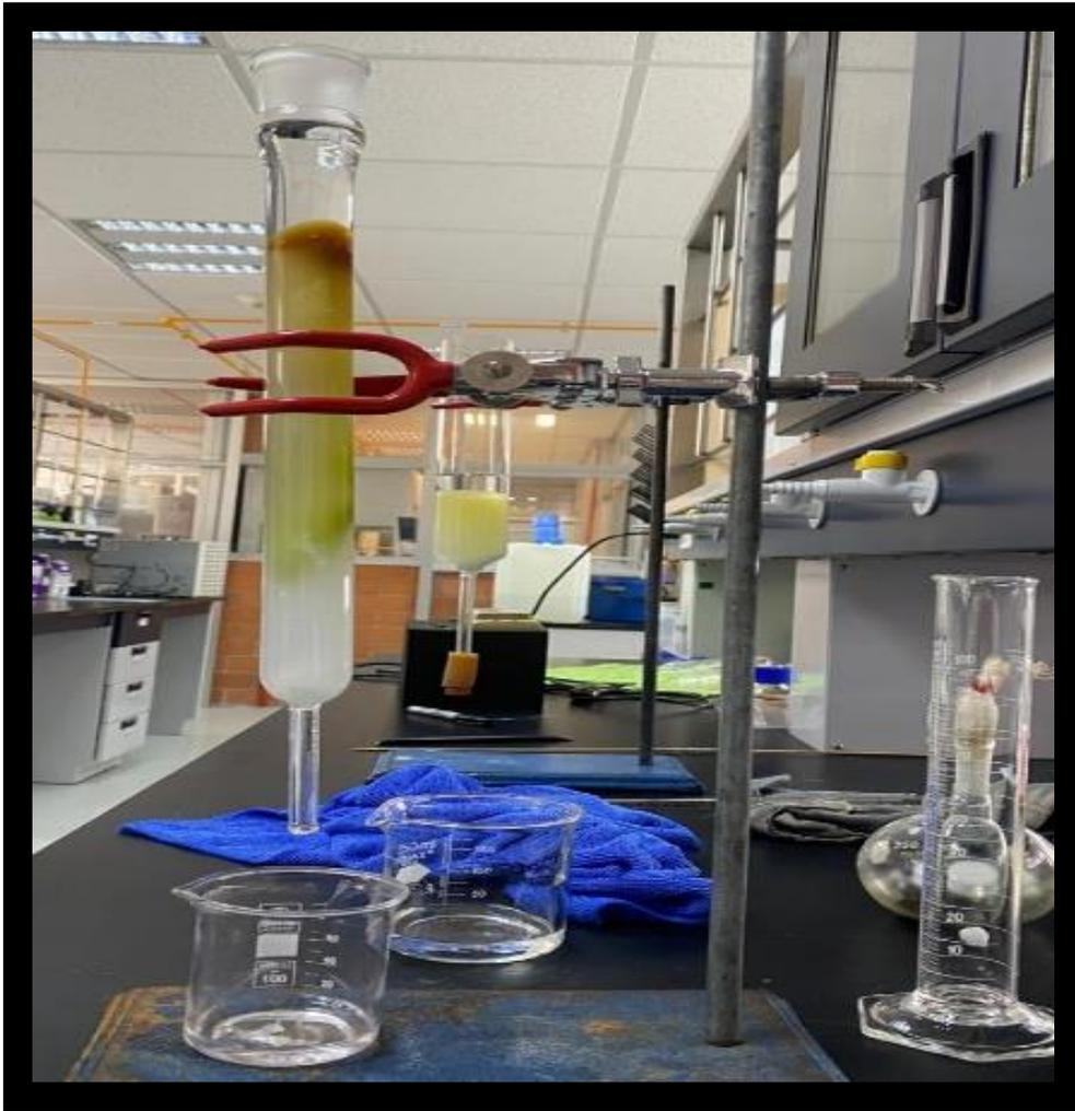
*Figura 20. Columna de separación con extracto metanólico de estróbilo de Pinus moctezume.*
