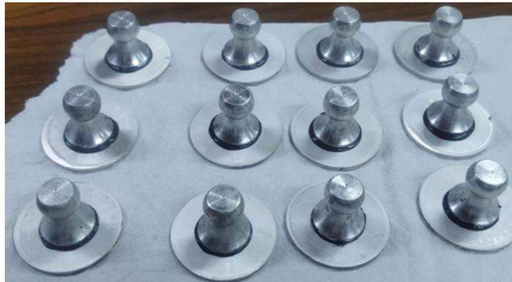
Figura 19. Muestras Mg-Al (AZ31) adheridas a los dollis de 20 mm listas para realizar las pruebas de adhesión.
