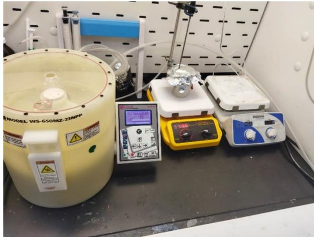
Figura 18. Equipo spin Coating, ala derecha parrilla con agitador magnético con la solución de PHB-Cloroformo.
