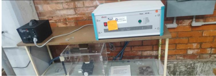
Figura 8.- Equipo generador de plasma a presión atmosférica [14].
