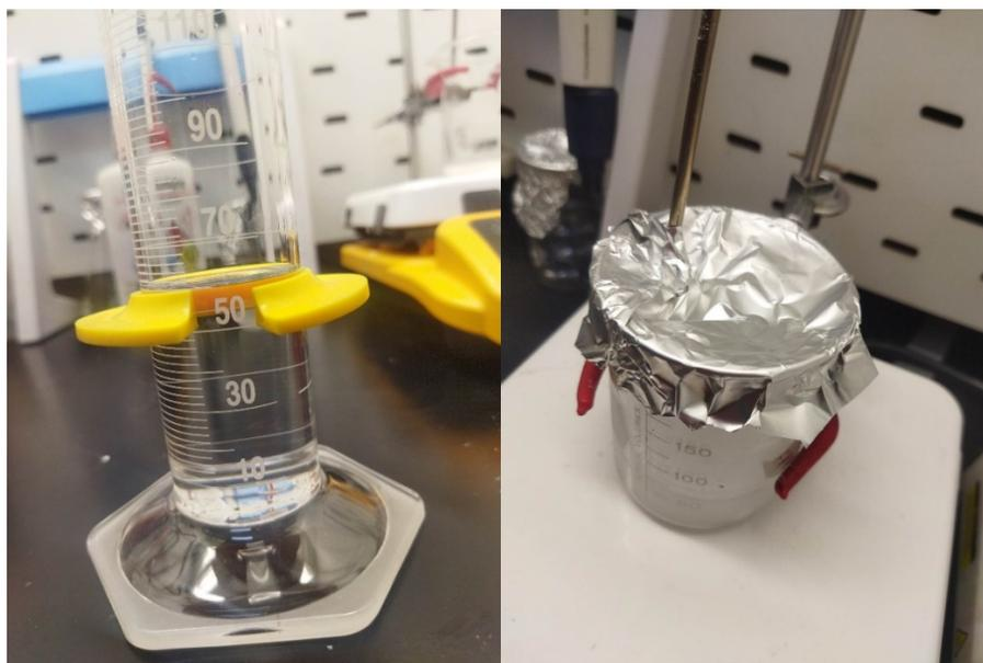
Figura 16. Medición del Cloroformo (60 ml) con ayuda de una probeta graduada.
