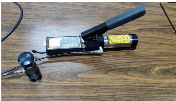
Figura 20. Equipo para la realización de las pruebas de adhesión.
