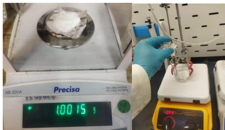
Figura 17. Medición de 1 gr de PHB para la disolución en vaso de precipitado.
