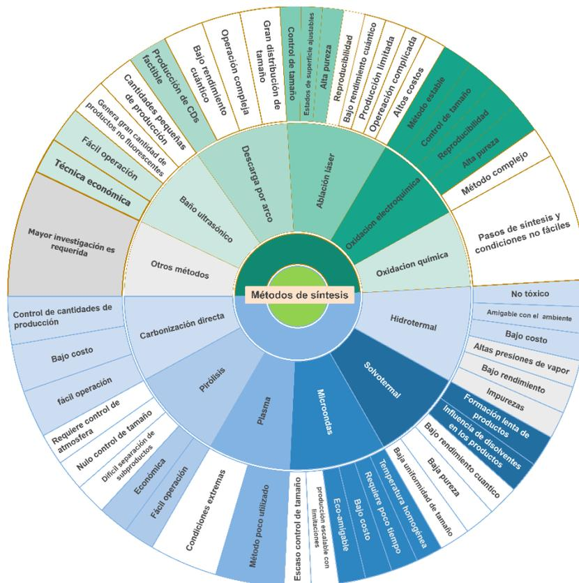
Figura 5. Métodos de síntesis de aproximación descendente (*top-down*) y aproximación ascendente (*bottom-up*).
