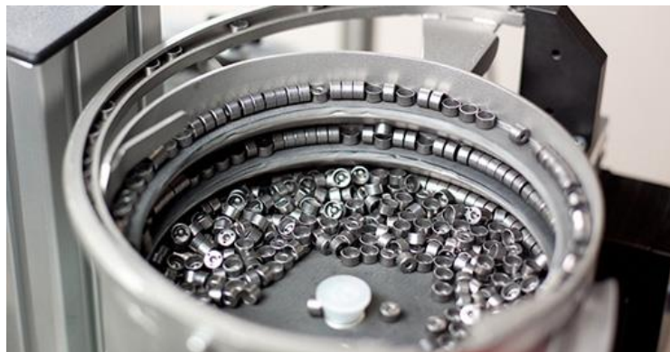
Figura 1 Tolva de abastecida con casquillo para alimentación
