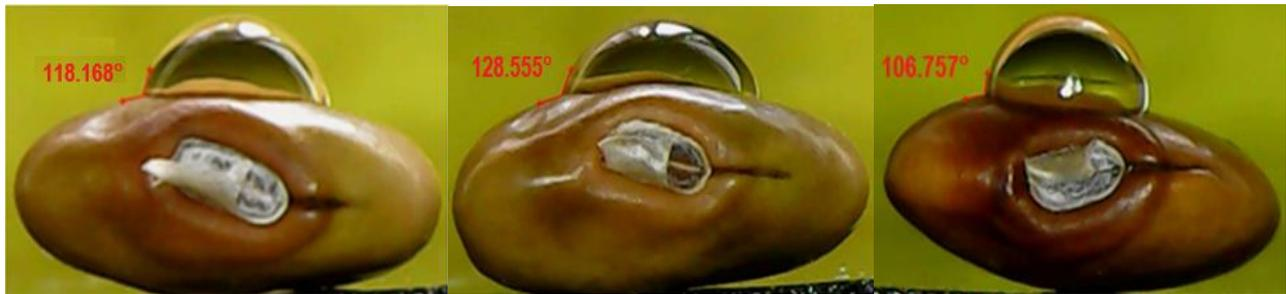
**Figura 7: Prueba de hidrofobicidad en semillas.**
