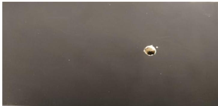
*Figura 11 Placa orificio pintada en color negro mate.*
