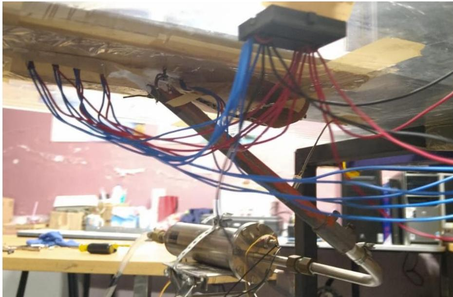
*Figura 12 Instrumentación de los sensores LM35.*
