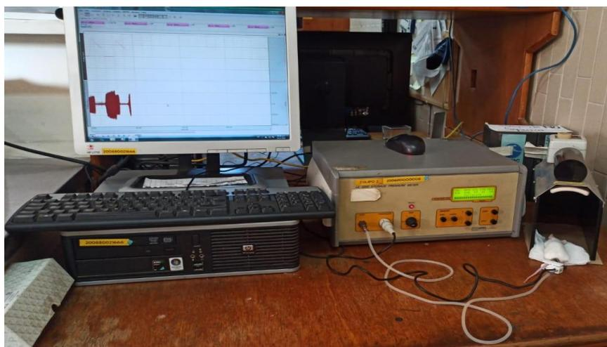
Figura 12. Equipo de adquisición de datos LE 5002 marca Biopac - Panlab – LETICA.
