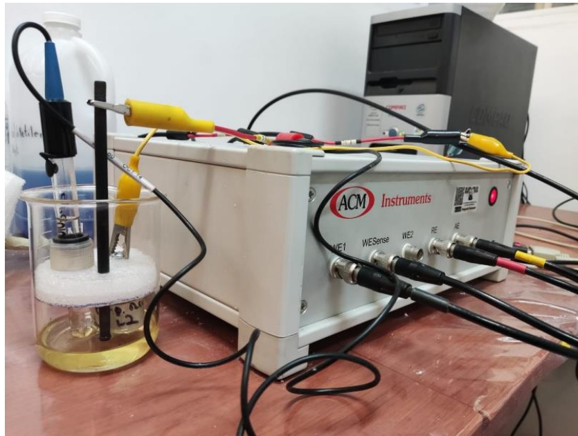
Figura 6 Potenciostato para pruebas electroquímicas tipo Gill de ACM Instruments.
