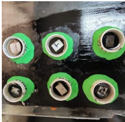
Figura 4 Preparación del encapsulado de las muestras para las pruebas electroquímicas en resina cristal.
