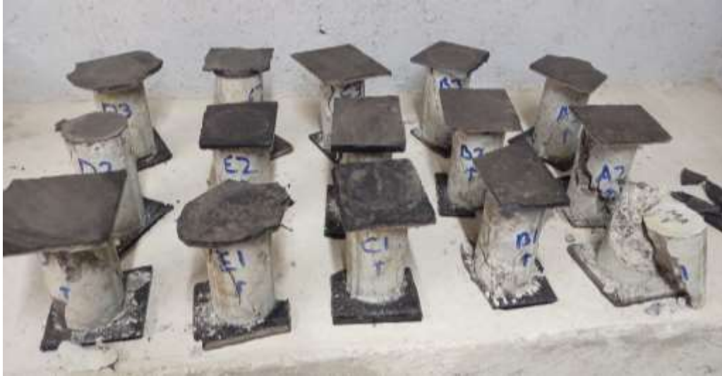
Figura 29. Muestras ensayadas. Presentan visibles fisuras en forma diagonal, lo cual es adecuado para este tipo de materiales.
