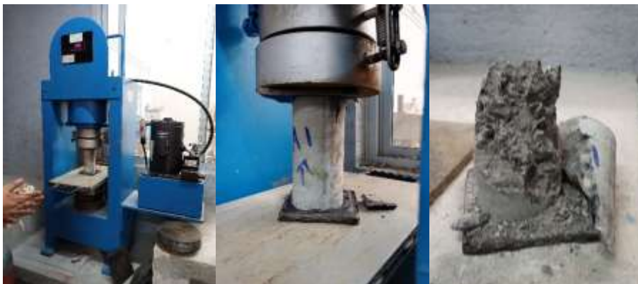
Figura 26. Ensayo compresivo sobre la muestra MA1. De izquierda a derecha se observa la colocación inicial, el desarrollo del ensayo y la fractura de la muestra. El procedimiento se replica para todas las muestras.
