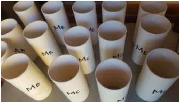
Figura 18. Moldes cilíndricos de PVC \varnothing 3"
