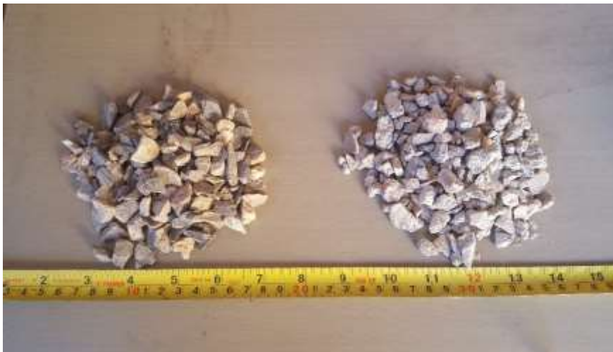
Figura 20. Agregado grueso de primera (izquierda) y agregado grueso reciclado (derecha), ambos con un tamaño máximo de 3/4".
