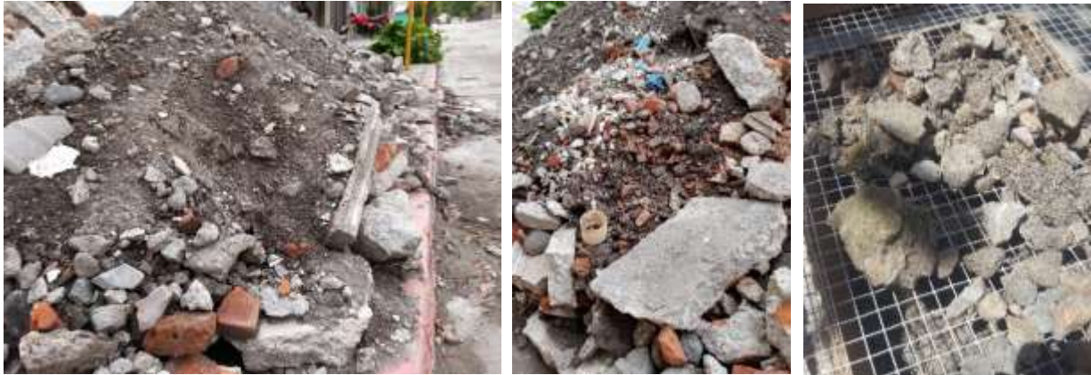
Figura 21. Selección y recolección de residuos provenientes de elementos de concreto simple.
