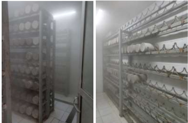
Figura 24. Cuarto húmedo en donde fueron depositadas las muestras para el proceso de curado de las mismas.
