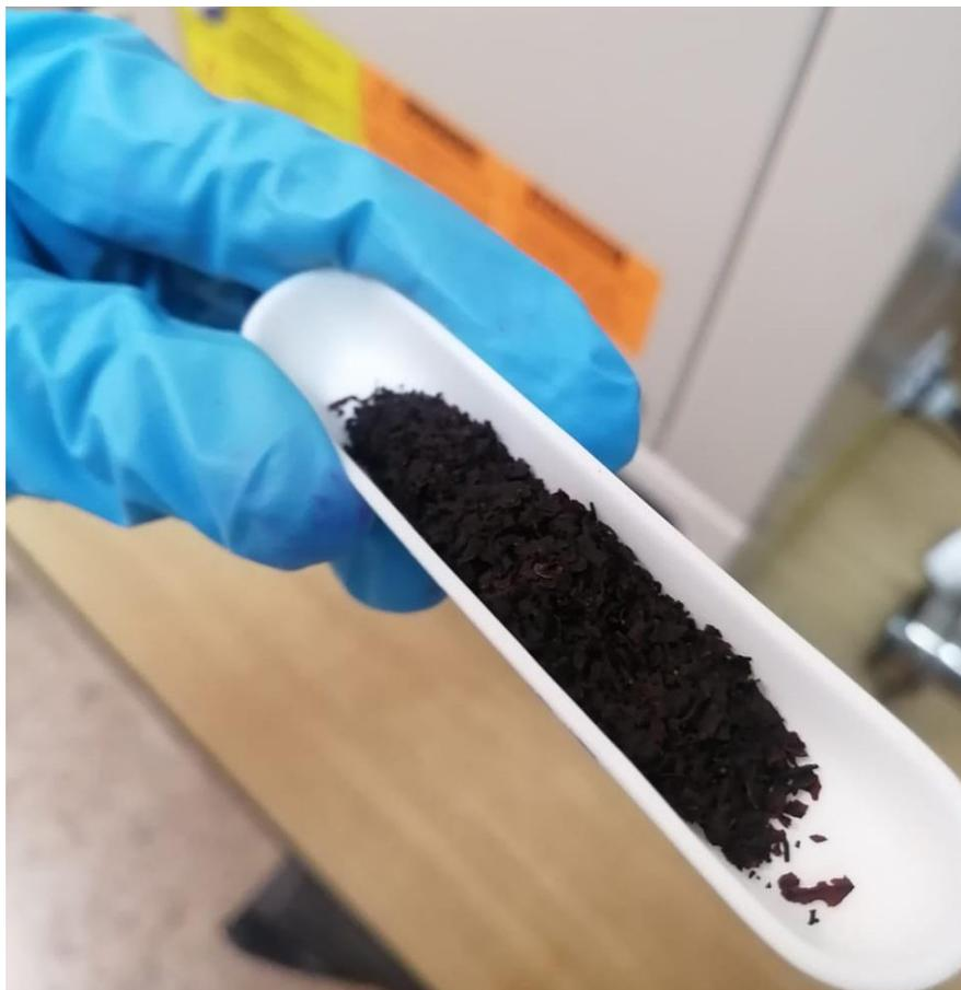
**Figura 3.3** Barca de alúmina con sargazo triturado antes del proceso de calcinación
