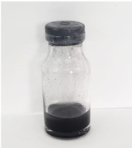
**Figura 3.5** Suspensión preparada con IPA y Nafión de la muestra CS-700A
