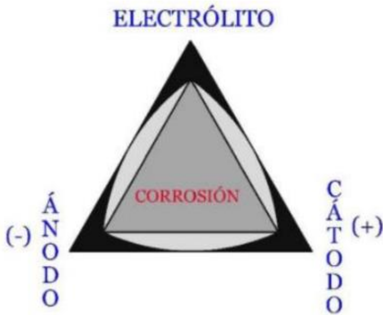
Figura 4. triángulo de la corrosión (Cifuentes, G. Garrido, B. Rojas, F. y Leiva, F. 2020)
