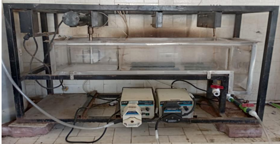
Figura 5-3. Vista frontal del prototipo del proceso de lodos activados modalidad Ludzack-Ettinger convencional
