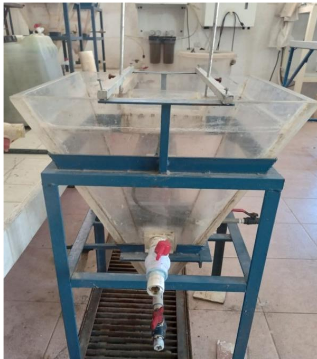
Figura 5-4. Vista frontal del clarificador utilizado para el prototipo del proceso de lodos activados modalidad Ludzack-Ettinger
