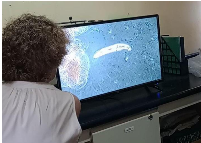
Ilustración 2-1. Vista microscópica de lodos activados PTAR IMTA
