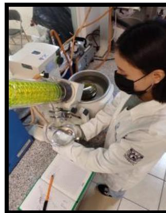
**Figura 12.** Destilación a presión reducida para la obtención del extracto
