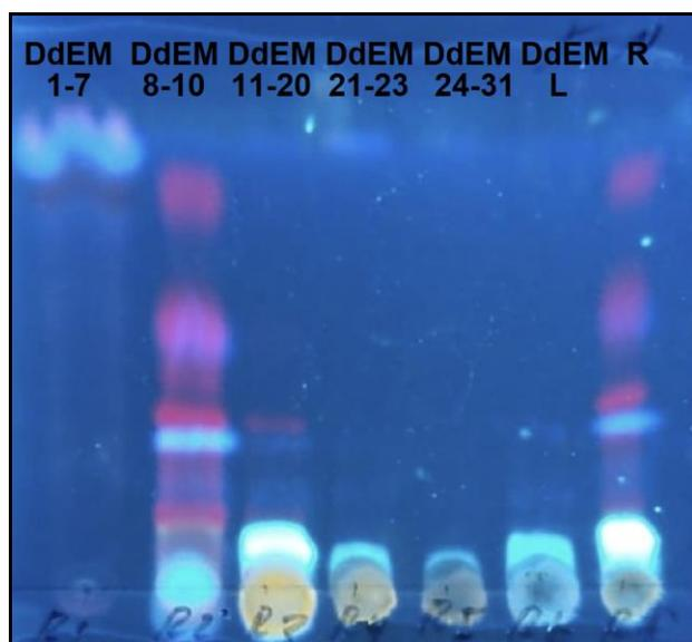
**Figura 54.** Placa de cromatografía de reuiones, fase normal, reveladas con NP-PEG (flavonoides), observada bajo luz UV de onda larga.
