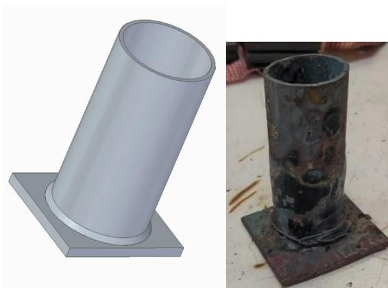
*Figura 15. a) Diseño de crisol en Solid Edge b) Crisol fabricado.*
