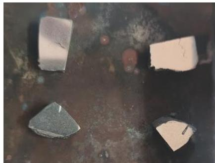
*Figura 28. Sinterizado de muestras. Se puede observar el cambio de color de las piezas.*
