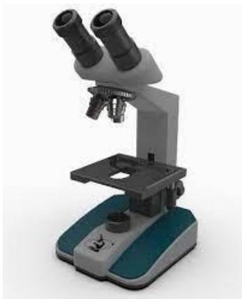
*Figura 23. Microscopio Óptico*
