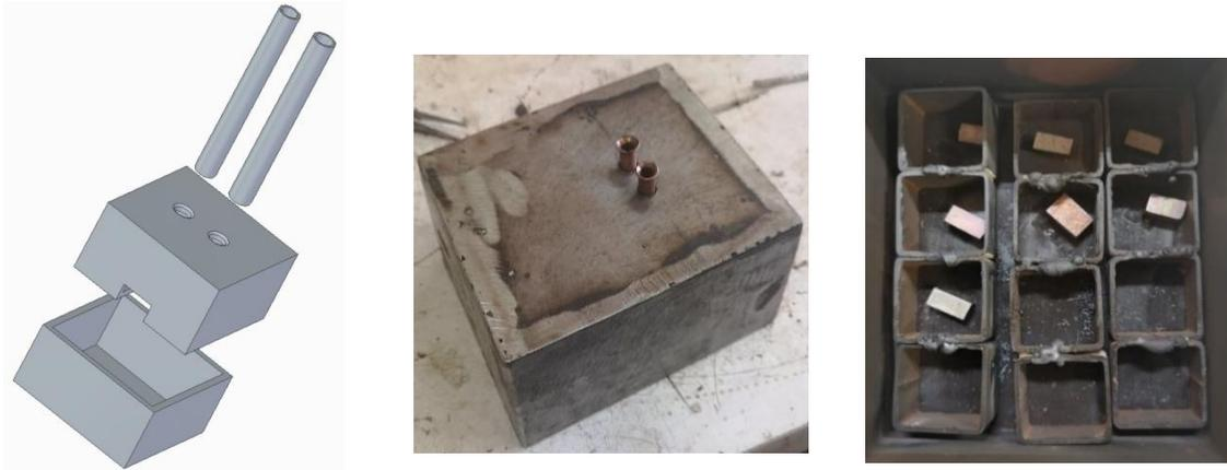
*Figura 17. Diseño de caja y fabricación de caja para circulación de Argón.*
