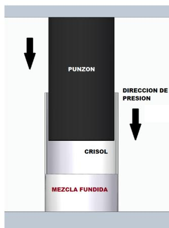
*Figura 13. Método de prensado en caliente*
