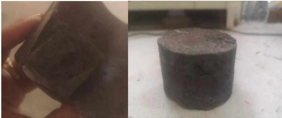
*Figura 16. a) Corte de crisol. B) Composito completo desmoldado.*
