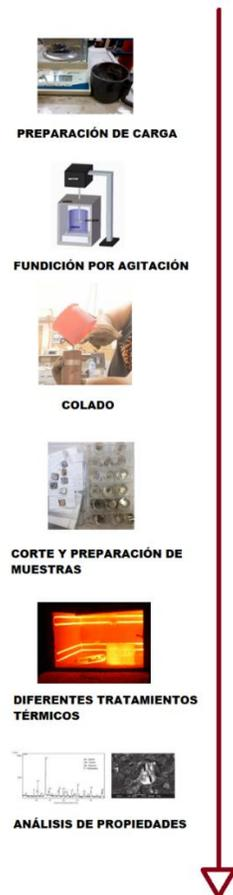
Figura 14. Proceso general de fabricación de composites
