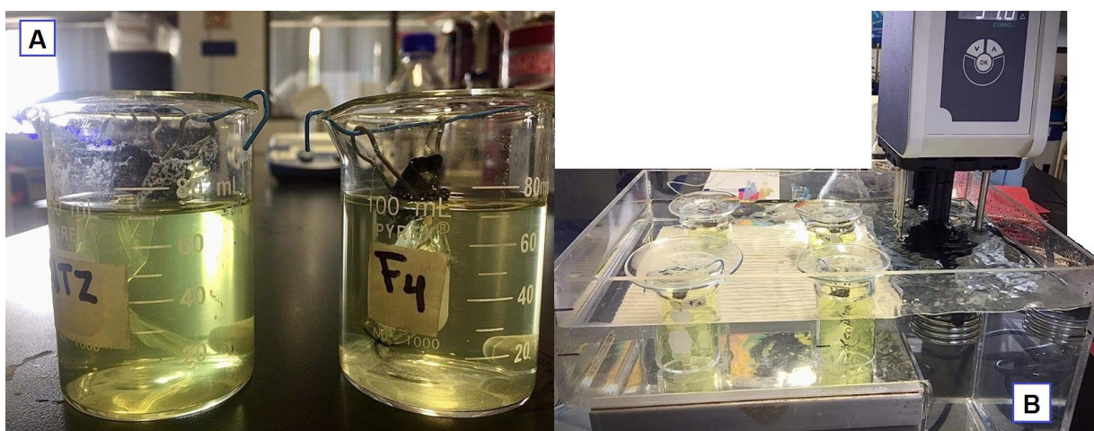
Figura 20. Liberación in vitro de NTZ y PNP-NTZ: A. Bolsas de diálisis con fármaco colocadas en el medio de liberación (buffer de fosfatos pH 6.8) y B. Sistema utilizado para el estudio de liberación in vitro .
