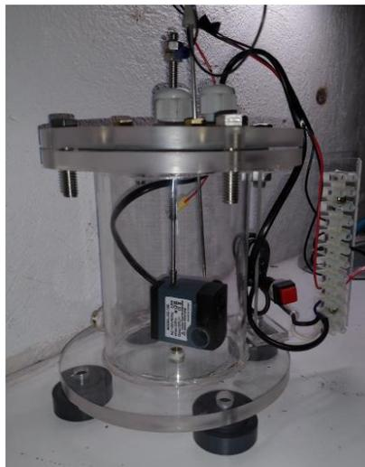
*Figura. 44 Fabricación y ensamble final de dispositivo de electrooxidación*
