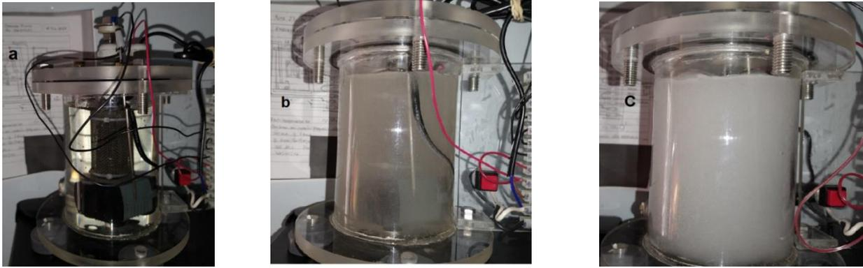
Figura.57. Prueba de oxidación de arreglo ánodo de Carbón de sello mec, CS vs SS304 separación 1/8, a) Condición del agua al comenzar el experimento, b) Formación de burbujas finas en la superficie del ánodo de malla de acero inoxidable a los 11 min. y 3100 mV, c) Formación de burbujas finas con una alta concentración desde los 15 min y 4100 mV a los 20 min. y 5500 mV
