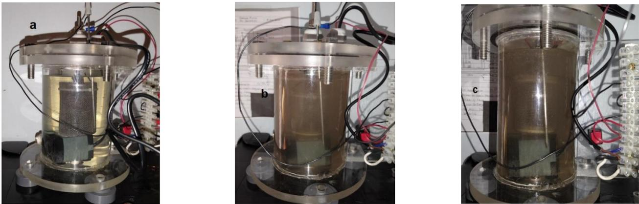
Figura 58 Prueba de oxidación de arreglo ánodo de Carbón de sello mec, CS vs SS304 separación 3/16, a) Condición del agua al comenzar el experimento, b) Formación de burbujas finas en la superficie del ánodo de malla de acero inoxidable a los 11 min. y 2890 mV, c) Formación de burbujas finas con mayor concentración a los 17 min. y 4100 mV
