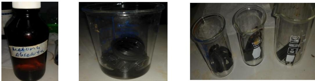
Figura.40 Limpieza de carbones con acetona
