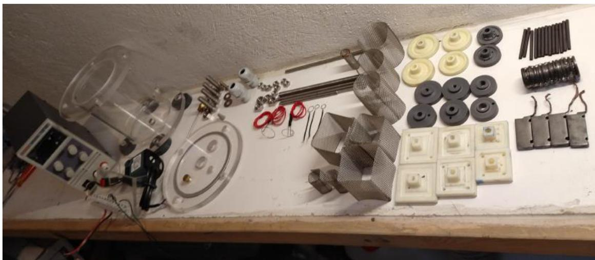
*Figura. 45. Despiece de los dispositivos electromecánicos y del dispositivo de electrooxidación, se visualizan todas las partes que se fabricaron*
