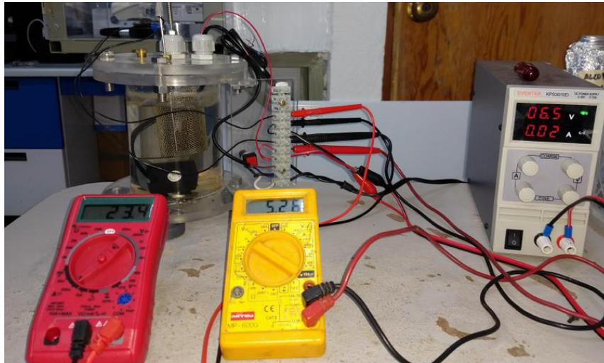
Figura.46 Conexión del dispositivo para caracterización eléctrica de los carbones CS, CE, CB.
