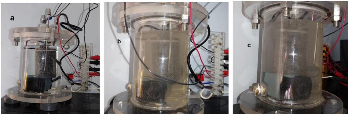
Figura 53. Prueba de oxidación de arreglo ánodo de Carbono de sello mec, CS vs SS304 separación 3/16, a) Condición del agua al comenzar el experimento, b) Formación de burbujas finas en la superficie del ánodo de malla de acero inoxidable a los 16 min. y 4620 mV, c) La formación de burbujas incremento muy poco hasta el final del experimento
