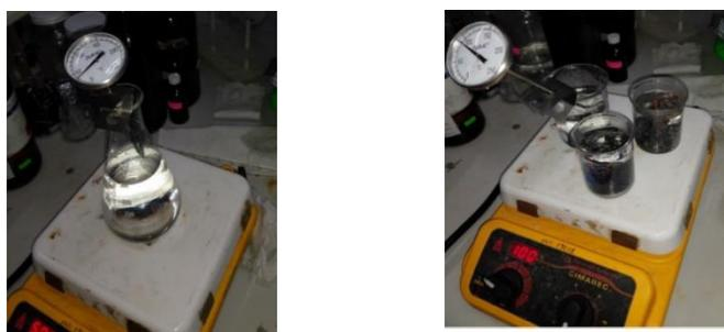
Figura 41 Limpieza de carbones con solución acida
