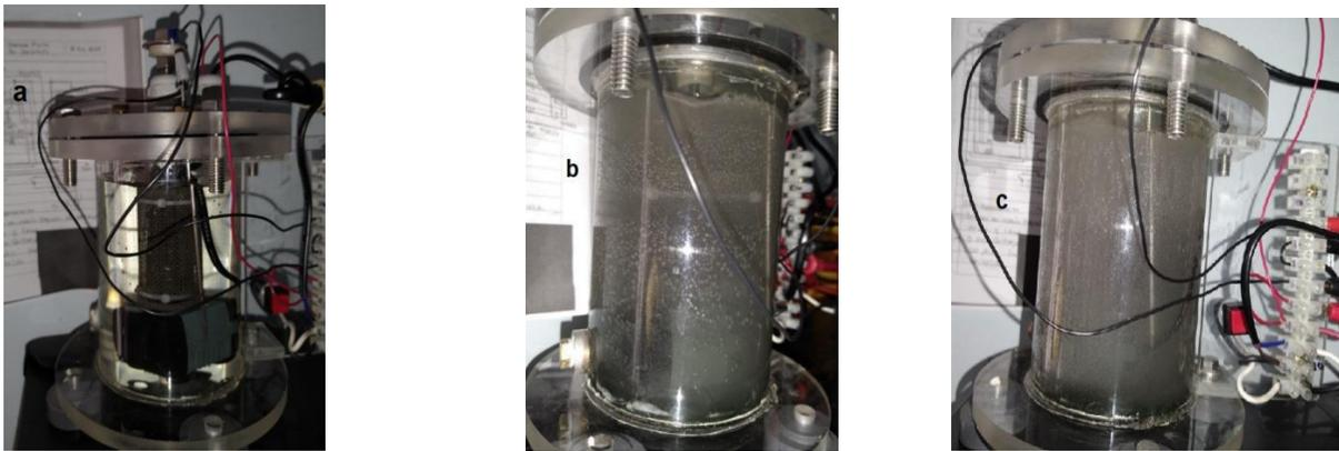
Figura 63 Prueba de oxidación de arreglo ánodo de Carbón de sello mec, CE vs SS304 separación 3/16, a) Condición del agua al comenzar el experimento, b) Formación de burbujas finas en la superficie del ánodo de malla de acero inoxidable a los 10 min. y 2000 mV, c) Formación de burbujas finas con una alta concentración a los 12 min. y 2400 mV
