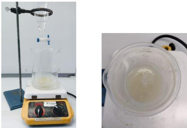
**Fig. 2.24** Agregación del H<sub>2</sub>SO<sub>4</sub> (por goteo)
