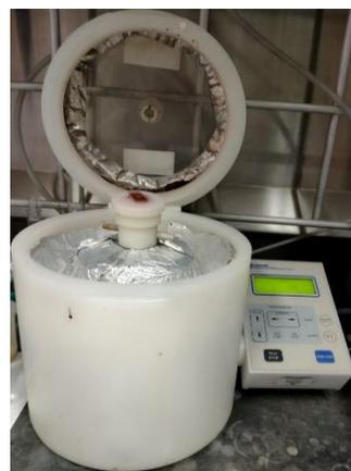
**Fig. 2.33** Equipo de spin-coater
