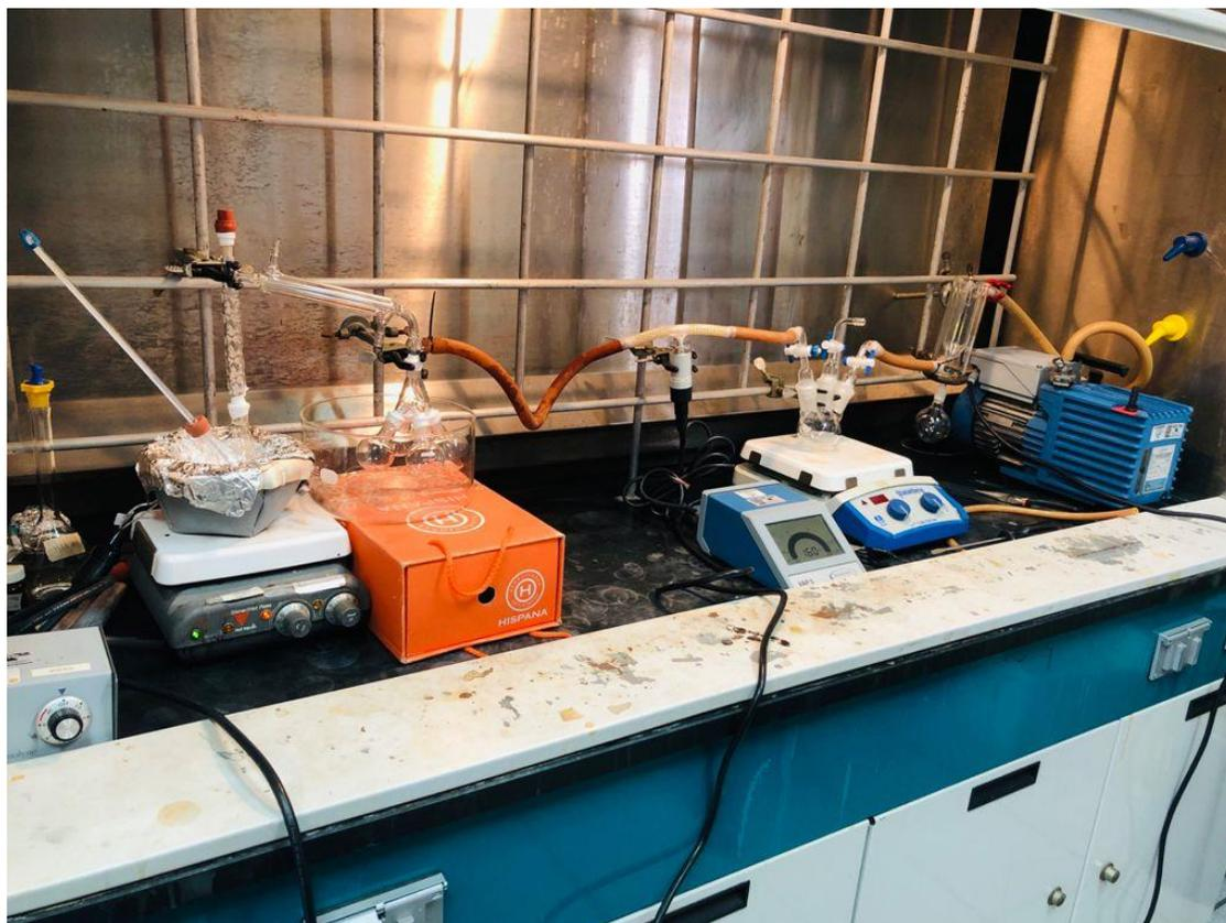
**Fig. 2.1** Armado de la destilación
