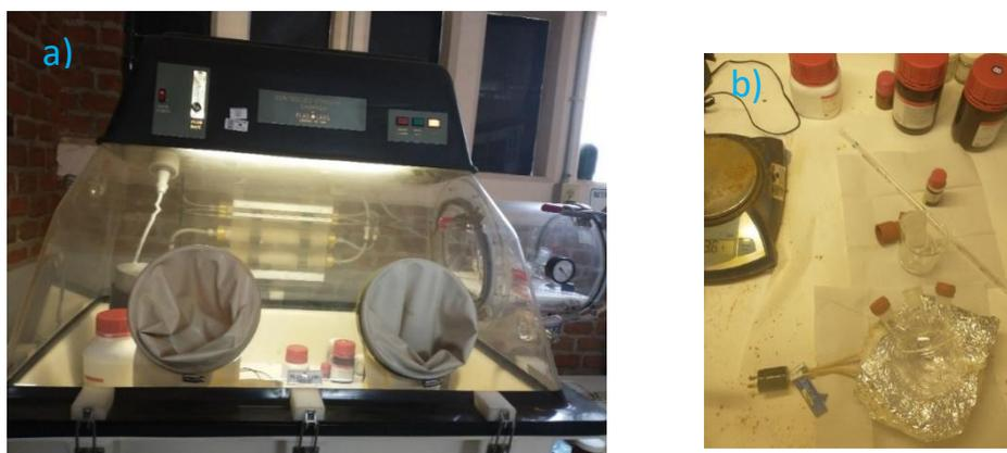
**Fig. 2.3** Cámara de guantes a) Parte externa y b) Parte interna
