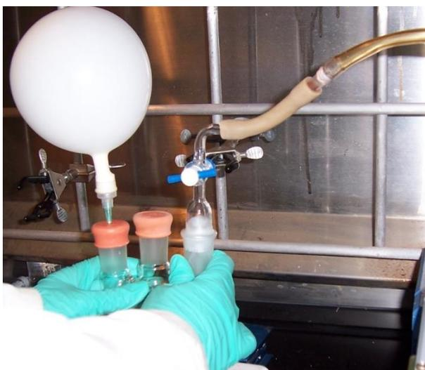
**Fig. 2.5** Purga con nitrógeno
