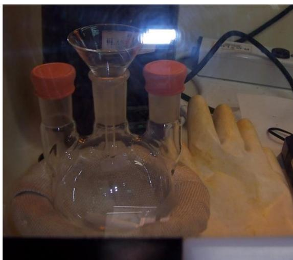
**Fig. 2.4** Matraz dentro de la cámara de guantes
