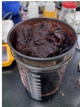
**Fig. 2.17** Filtrado con malla 200  $\mu\text{m}$
