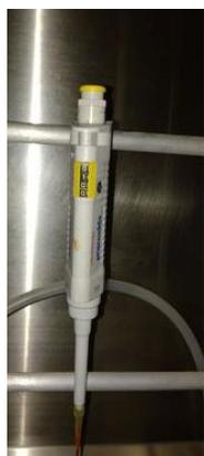
**Fig. 2.32** Micropipeta a 10 $\mu$ l
