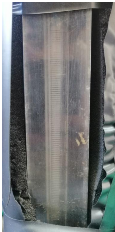
Figura 3.12 Flujómetros de la mezcla absorbente.
