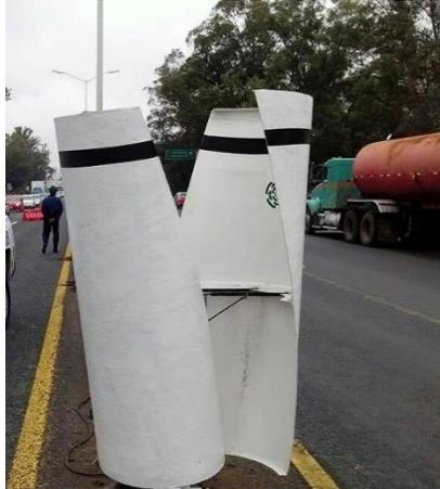
Figura 1.1 Aerogenerador de eje vertical
