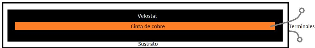
Figura 4.3: Diagrama de la configuración de los elementos del sensor flexible(vista superior).
