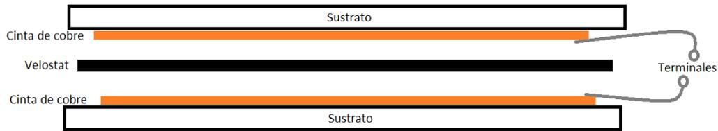
Figura 4.2: Diagrama de la configuración de los elementos del sensor flexible(vista lateral).
