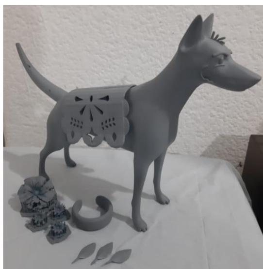
En la figura 65 se puede observar que el acabado que le entrego a los tesistas por parte del proveedor. Fue en color gris. Se procedió a preparar las piezas del prototipo para un pintado con pintura acrílica tipo “primer”. Cabe señalarse que en caso de entrar a una producción industrial; el cuerpo del perro será impreso en una sola pieza y sin necesidad de resanar.
