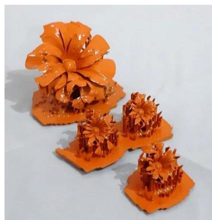
Como se puede observar en la figura 65 las piezas de las flores nos fueron entregadas con una base y soportes. Tras el pintado de estas se intentó retirar los soportes conectados a la base, pero se notó que algunos pétalos se rompían pues estaban muy delgados. (véase figura 68). Se optó por no retirar estos soportes para no destruir la pieza. Por lo que encontramos que es una oportunidad para mejorar el diseño de la flor de cempasúchil.
