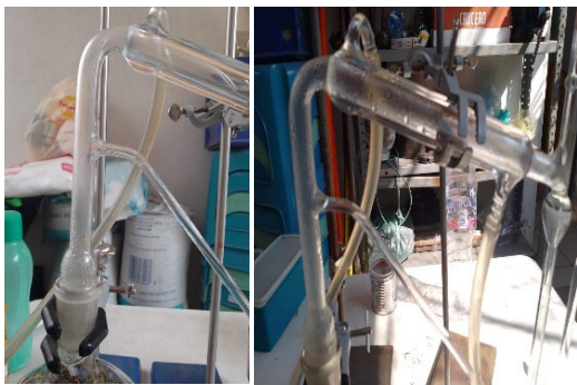
Figura 13. Destilación de aceite de romero
