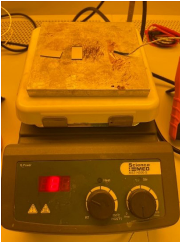
FIGURA C.10. Tratamiento de calor aplicado al sustrato, se usó una temperatura de aproximadamente 115 °C, por un periodo de 5 min.
