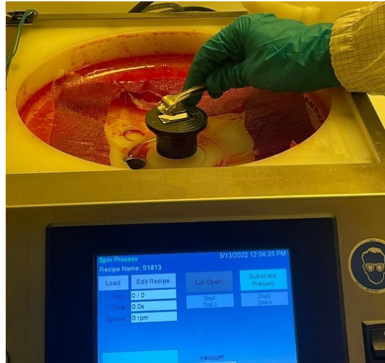
FIGURA C.9. Colocación del sustrato en el equipo de Spin Coating.
