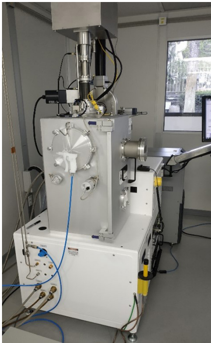
FIGURA C.3. Equipo para depositar películas de diversos metales por evaporación de haz de electrones "e-beam".
