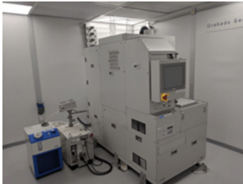
FIGURA C.20. Equipo DRIE del cuarto limpio de CIDESI sede Querétaro. Imagen tomada de [2].
