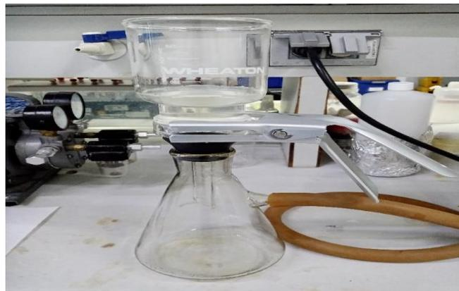
Figura 11. Filtración de muestras al vacío.
