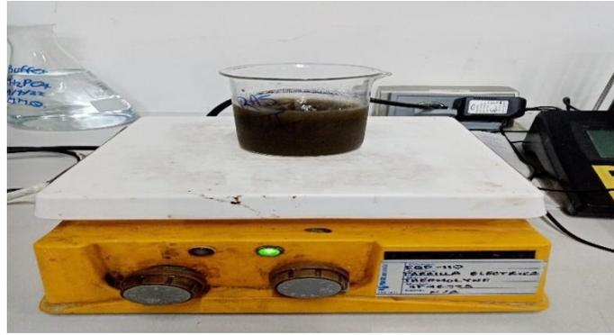
Figura 9. Agitación de muestras (600 rpm).
