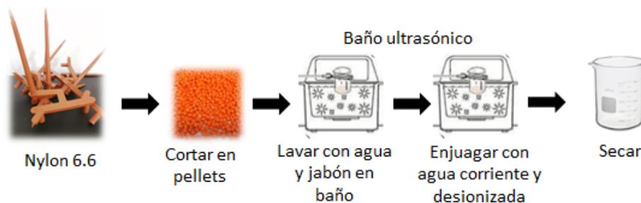
Figura 16. Limpieza del nylon reciclado en pellets
