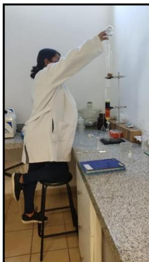
**Figura 9.** Columna cromatográfica abierta
