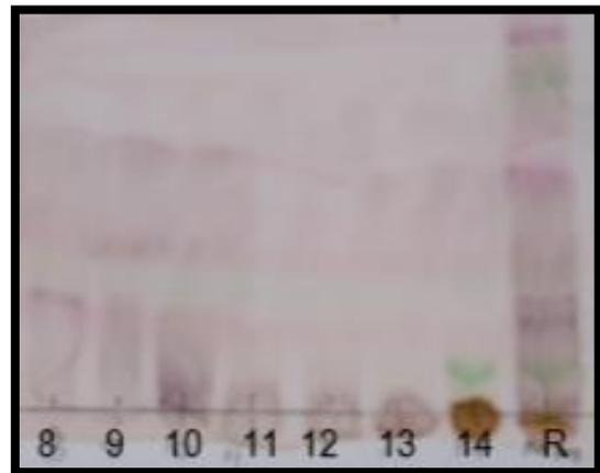
**Figura 17.** Placa cromatográfica en fase normal eluída en una proporción 95:5 diclorometano-metanol, revelada con Sulfato cérico amoniacal revelador terpenos.
