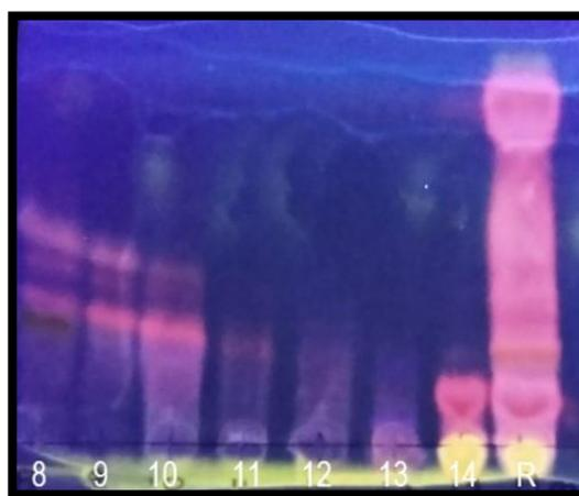
**Figura 13.** Placa cromatográfica en fase normal eluída en una proporción 95:5 diclorometano-metanol, revelada con detección de flavonoides y luz UV de onda larga (365 nm).
