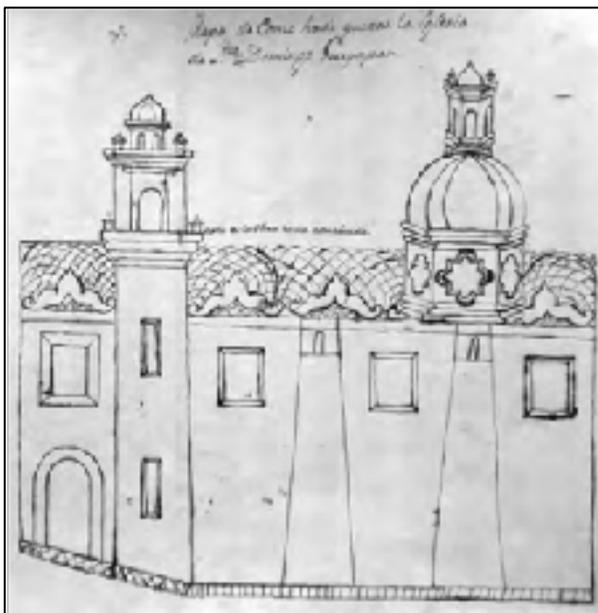
Fig. 4. Este dibujo tomado de Ledesma Gallegos<sup>19</sup> se aprecia el proyecto de remodelación de la Iglesia de Santo Domingo en Hueyapan, donde se agregaron los dos contrafuertes, siendo uno de ellos el del lado este el que nos ocupa.
