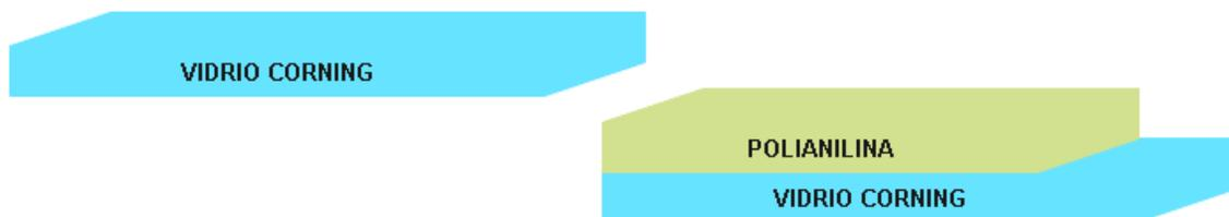
Figura 26 Deposición de los materiales para su caracterización
