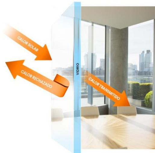
Figura 4. Esquema general del uso de una ventana inteligente [3].
