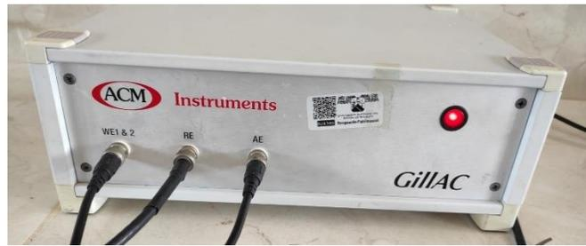
**Figura 21.** Potenciostato Gill AC.
