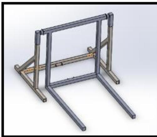
Figura 3.7 Diseño de estructura de inclinación para contenedores.
