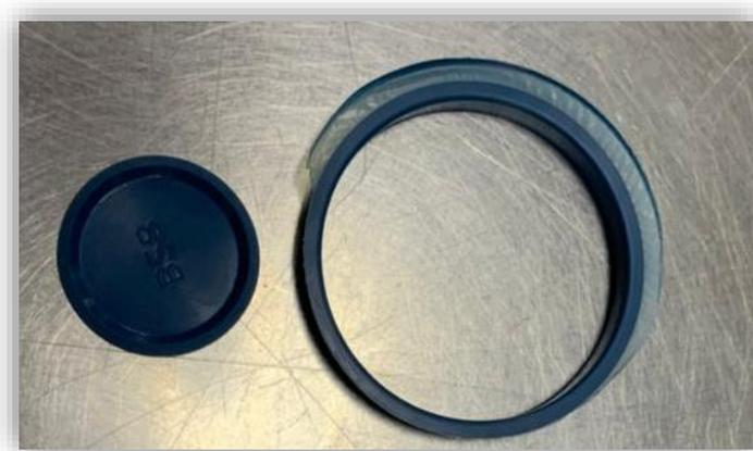
**Figura 5: Exceso de rebaba retirada.
