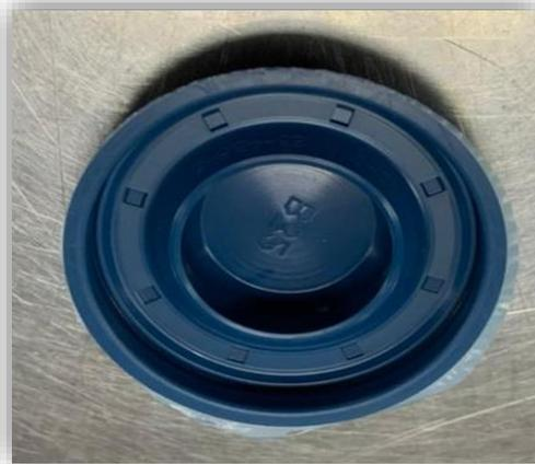
**Figura 3: Pieza moldeada con exceso de rebaba.**
