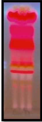
**Figura 16.** CmED, 95:5 diclorometano-metanol, LUV onda larga
