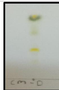
**Figura 15.** CmED, 95:5 diclorometano-metanol. Revelado con NP-PEG
