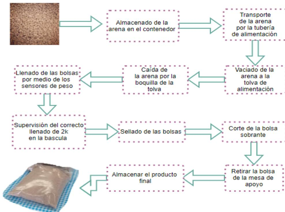
Figura 3.13 Representación del proceso de llenado de las bolsas de arena
