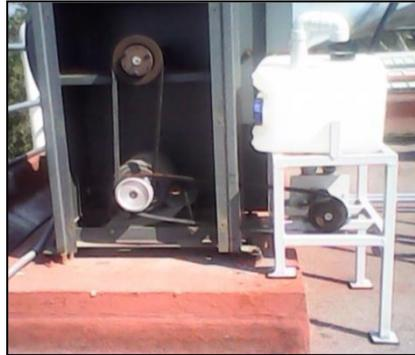
*Ilustración 14 Sistema mecánico de suministro de ML y VL*
