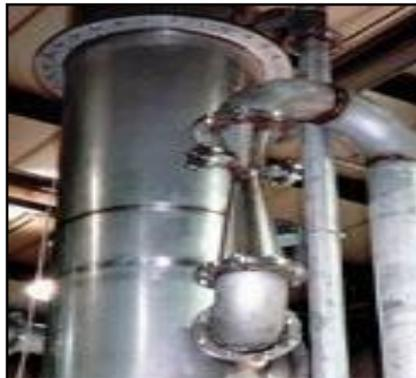
*Ilustración 4 Lavador húmedo de gases con Venturi de alta energía [Branch Env. Corp, 2004]*
