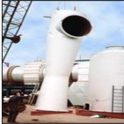
*Ilustración 5 Lavador húmedo de gases con Venturi tipo Jet [Branch Env. Corp, 2004]*
