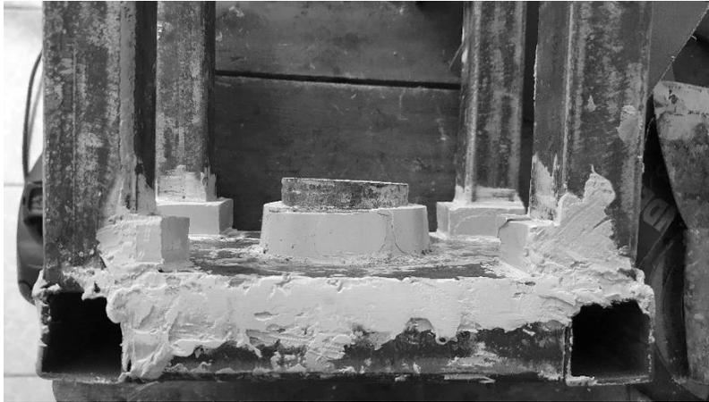
*Figura 4.12 Aplicación de bondo placa hembra*
