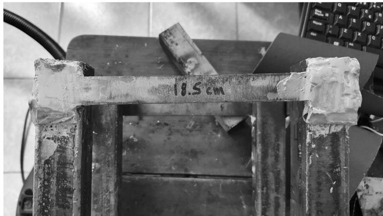
*Figura 4.13 Aplicación de bondo en solera*
