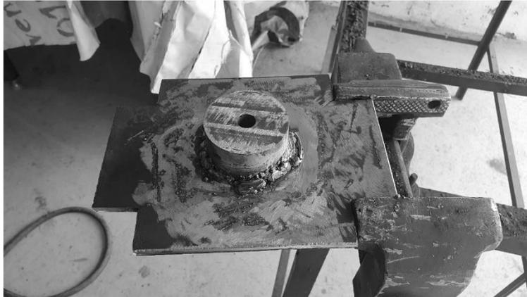
*Figura 4.7 Pieza hembra soldada a placa*
