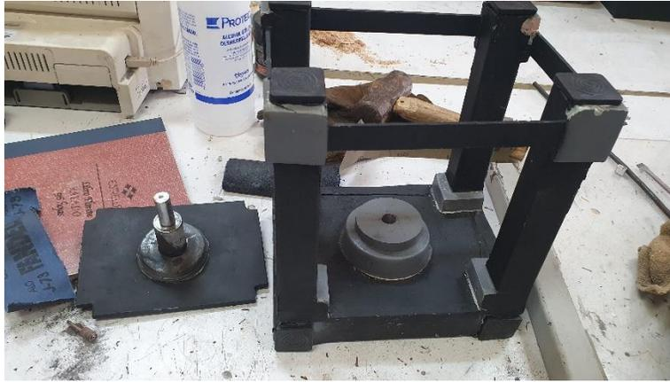
*Figura 4.18 Maquina de extrusión fabricada*
