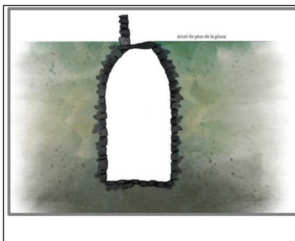
Figura 128. Corte de un depósito de agua "tipo" de Cantona. Tomado de: Revista de Arqueología Mexicana. No. 73. Especial, 2017. Disponible en: https://arqueologiamexicana.mx/indice-general/ediciones-especiales (Consultado el 23 de Enero del 2019).
