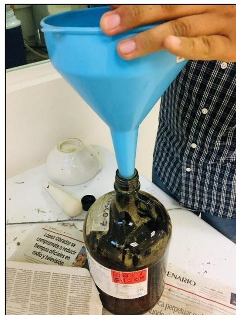
*Fig. 19. Incorporación de la arenisca de la planta y acetona en el frasco para la maceración.*
