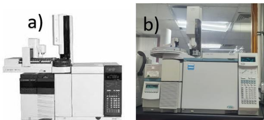
Figura 19. a) sistema de cromatografía de gases (cg) 7890b (Agilent technologies) acoplado a un espectrómetro de masas triple cuádruplo (QQQ) 7000d (Agilent technologies); b) sistema de cromatografía de gases (Agilent technology) 6890 acoplado a un detector de masas 5973 N, en un modo de ionización por impacto electrónico
