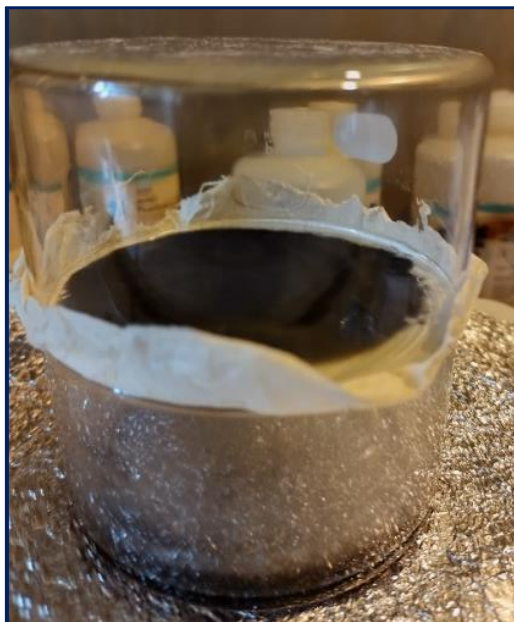
Figura 3.4-1 Malla de fibras de PVA deshidratada.
