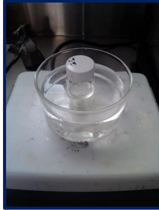
Figura 3.2-1 El PVA con agua destilada en agitación magnética y calentamiento.
