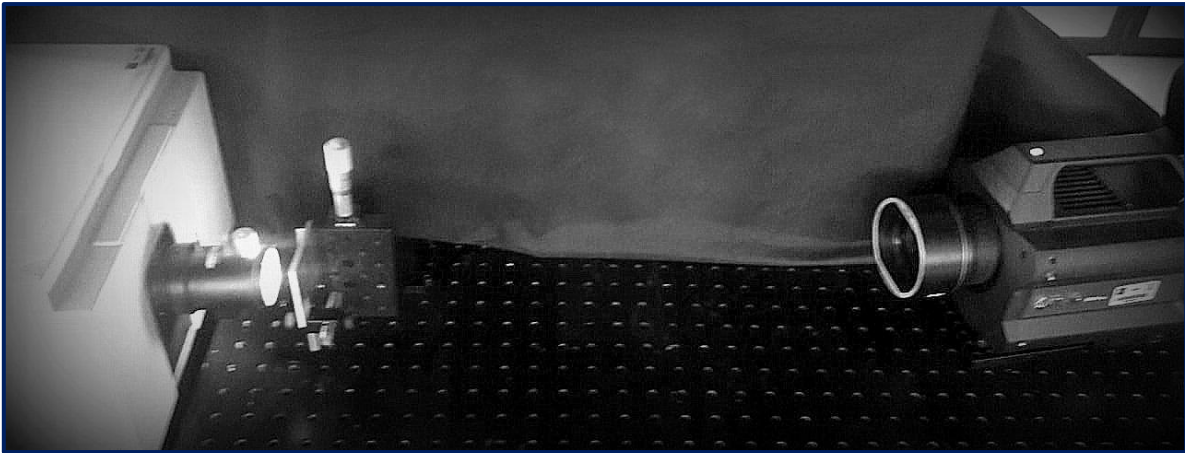
Ilustración 12 Arreglo experimental para la medición de temperatura por Termografía-IR.
