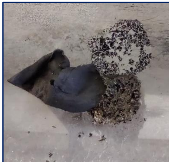
Figura-3.5-2 Muestra pulverizada tras el proceso de carbonización.
