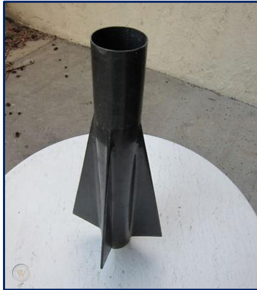
Figura 2.4-2 Modelo de cohete fabricado con fibra de carbono.
